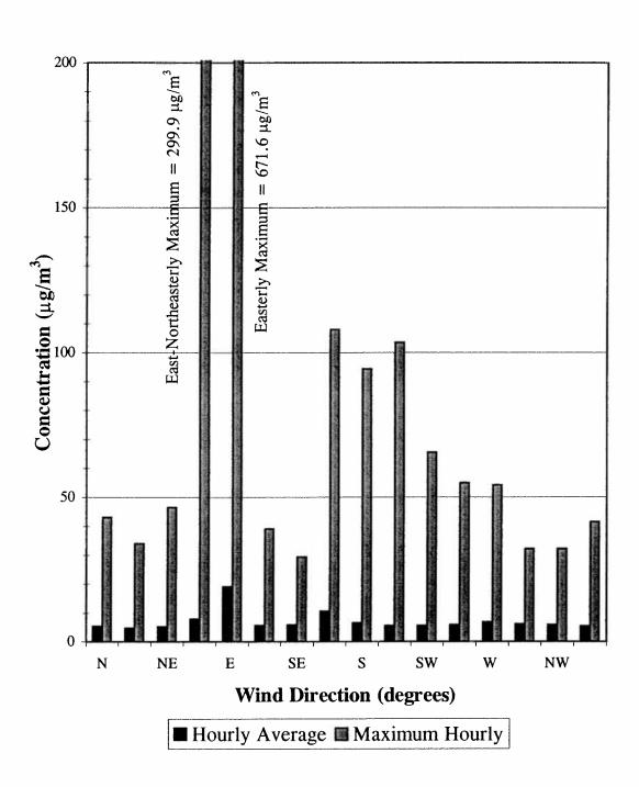
FIGURE 3-7: PM<sub>10</sub> CONCENTRATION BY WIND DIRECTION
