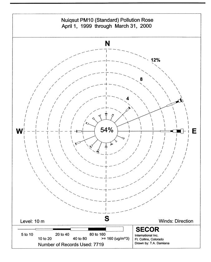
FIGURE 3-6:  $PM_{10}$  FREQUENCY ANALYSIS BY WIND DIRECTION
